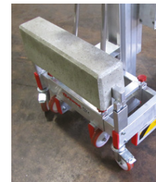
HW.S5 Base zavorrata per evitare lo sbalzo frontale, zavorra varia in base all'altezza ed alla portata. Ballasted base to avoid front overhang, ballast varies according to height and capacity.
