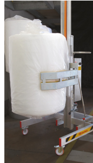
HW BIG con HW.PI, pinza di presa idraulica per sollevamento bobine. HW BIG with HW.PI, hydraulic gripper for lifting reels.
